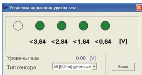
Рис. 8 Установка порогов светодиодов
